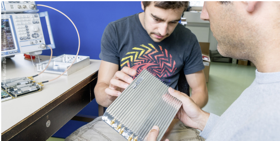
Die an der Berner Fachhochschule entwickelte Plattform für Software Defined Radio. In dem gefrästen Alugehäuse ist das komplette DAB+ Einsprech- und Repeatersystem untergebracht. Das Audio- und Lichtwellenleiter-Übertragungssystem für die Verteilung der Funksignale im Tunnel sowie Empfangsantennen lässt sich direkt anschliessen.
